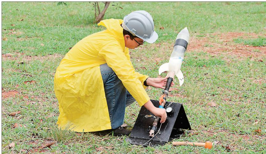
Os estudantes construíram o foguete a partir de garrafas pet, utilizando sistema de água e ar comprimido em alta pressão
